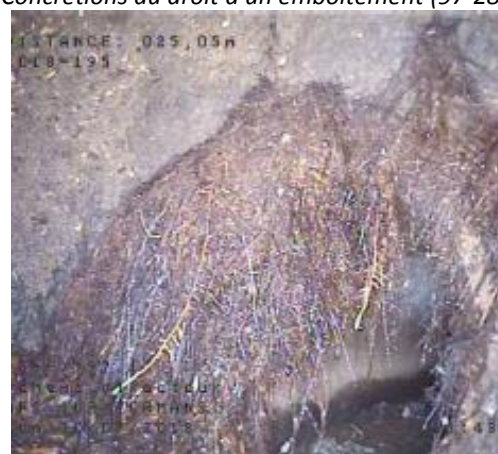
Racines au droit du regard 285, nouvellement identifié (base de données mise à jour en conséquence)
