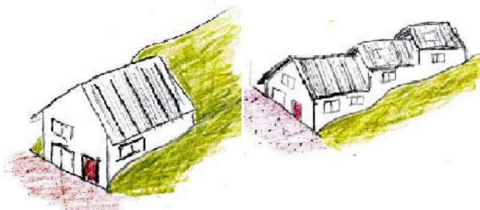
Principe d'intégration dans la pente. (tdu)
