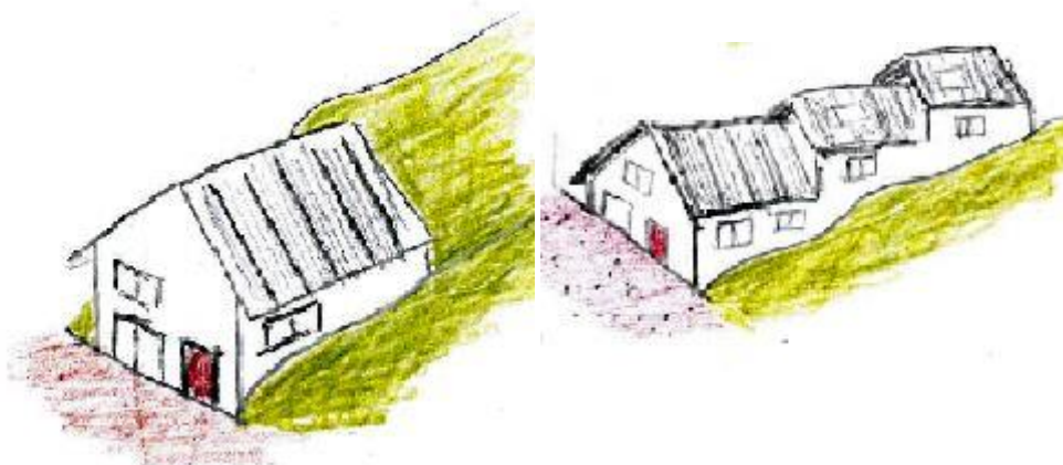
Principe d'intégration dans la pente. (tdu)
