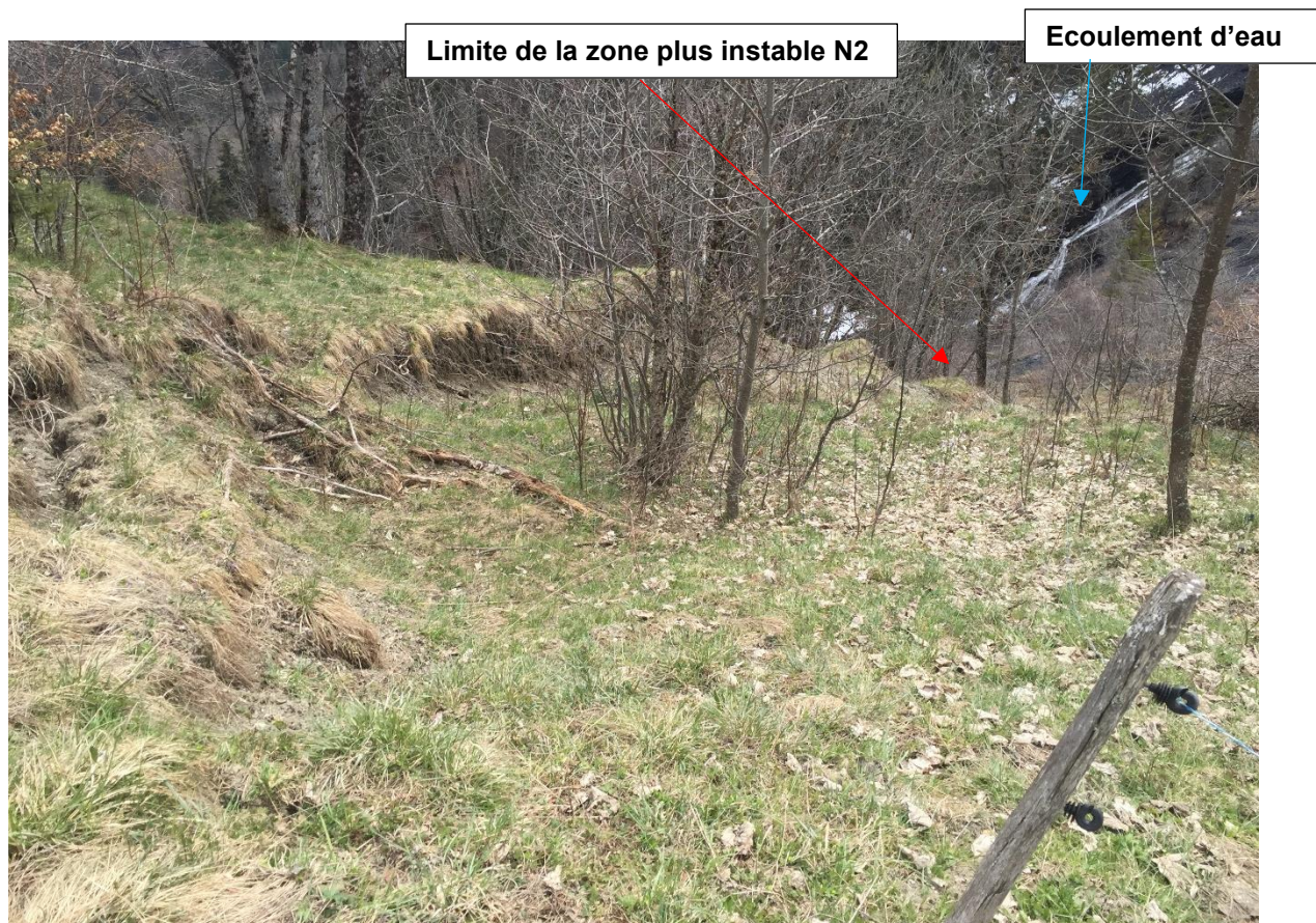
Photo 10 : repère 10 sur la figure 1, limite latérale rive gauche de la niche d'arrachement noté N1
