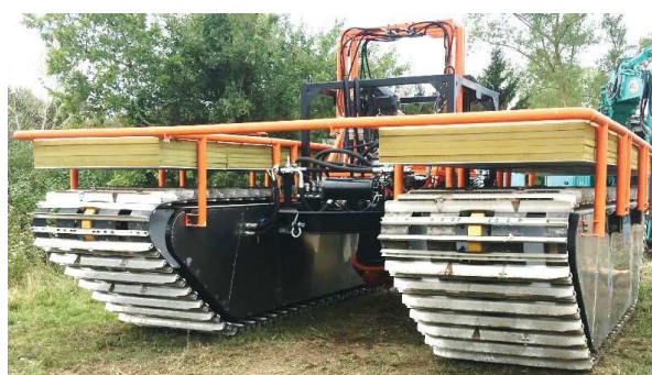
Figure 2 : Schéma de principe du projet et moyen de dragage envisagé (NESSIE = outil innovant de dragage co-développé EDF / WATERTRACKS).
