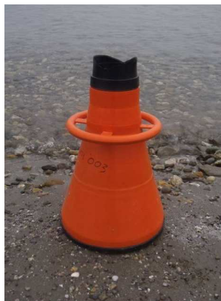
Figure 6 : Bathyscope; la face inférieure vitrée permet de supprimer les reflets de la surface de l'eau, même en présence de clapot
