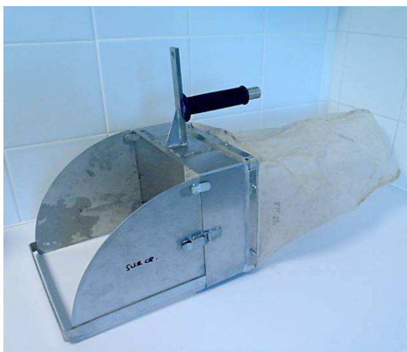
Figure 8 : Filet de type "Surber", utilisé pour les prélèvements d'invertébrés
