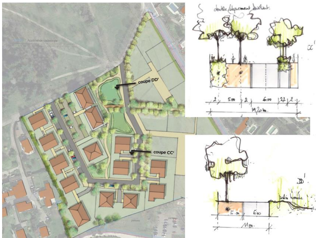
Figure 10 : conception d'un jardin humide (Coupe DD') © QUI PLUS EST 2018
