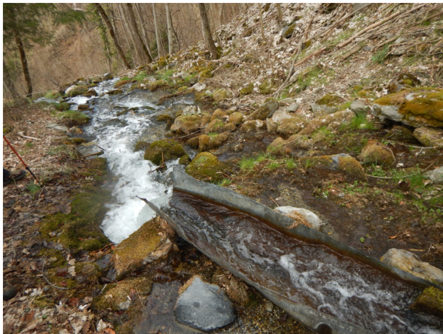
Figure 8 - la goulotte ayant servi à la mesure régulière des hauteurs d'eau
