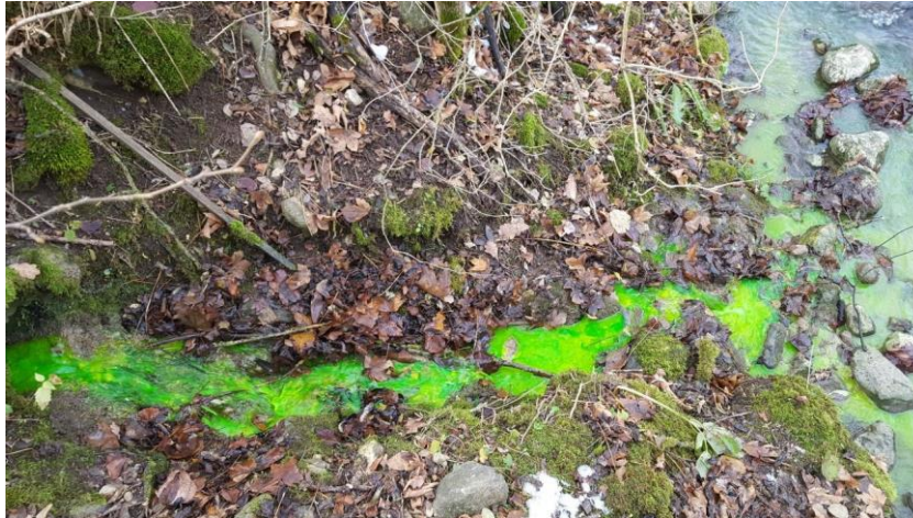
Point de rejet du projet du secteur de la BUCCA dans le ruisseau « Le Bévoué » après traçage avec de la Fluorescéine
