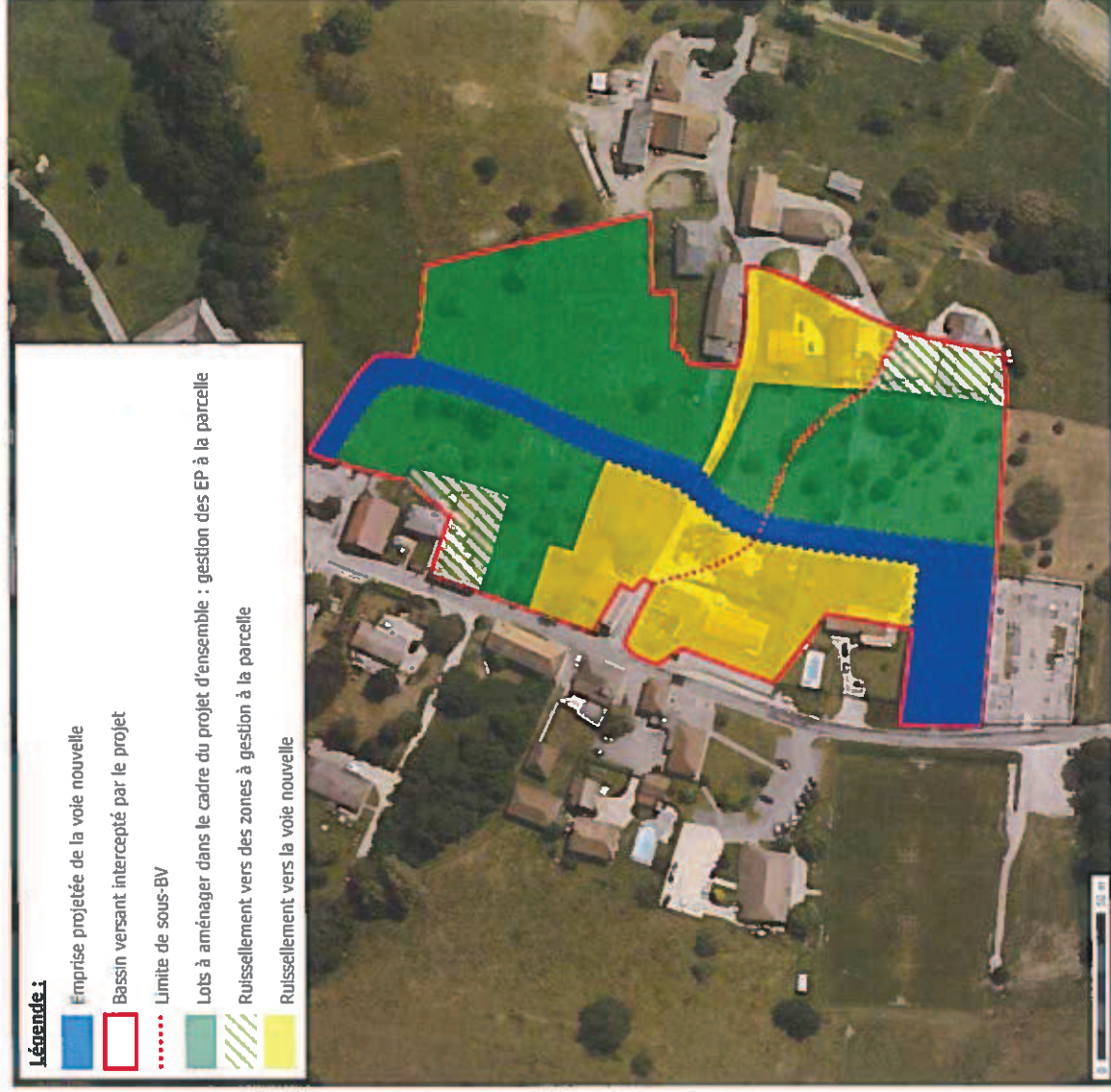
Figure 6 : Gestion des eaux pluviales sur le bassin versant ouest intercepté par le projet
