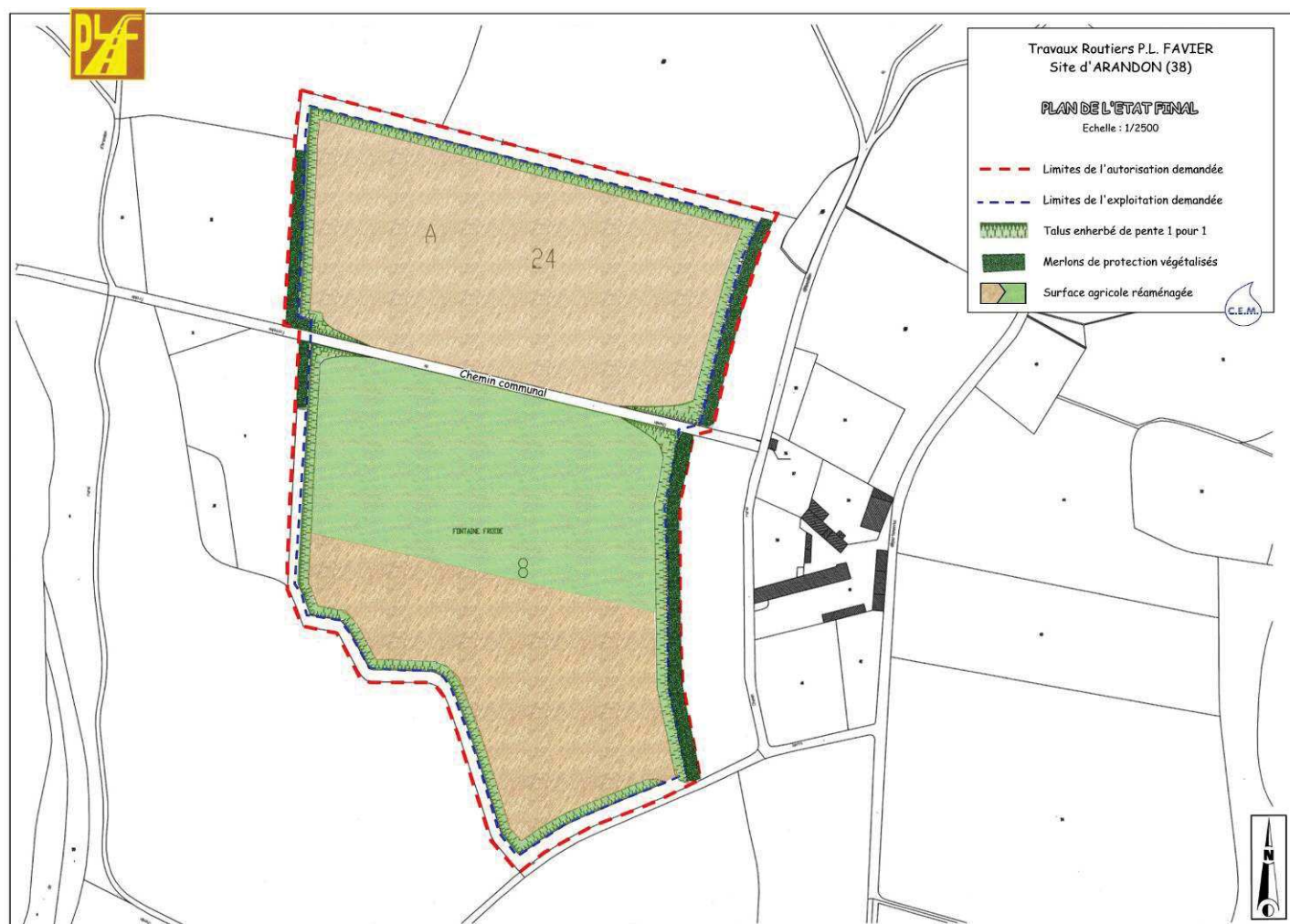
Figure 8 : Plan de remise en état de la carrière de Fontaine Froide (CEM 2005)
