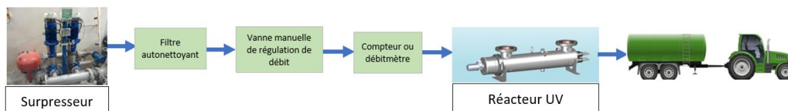
Figure 26 : Principe de fonctionnement des installations de REUT
