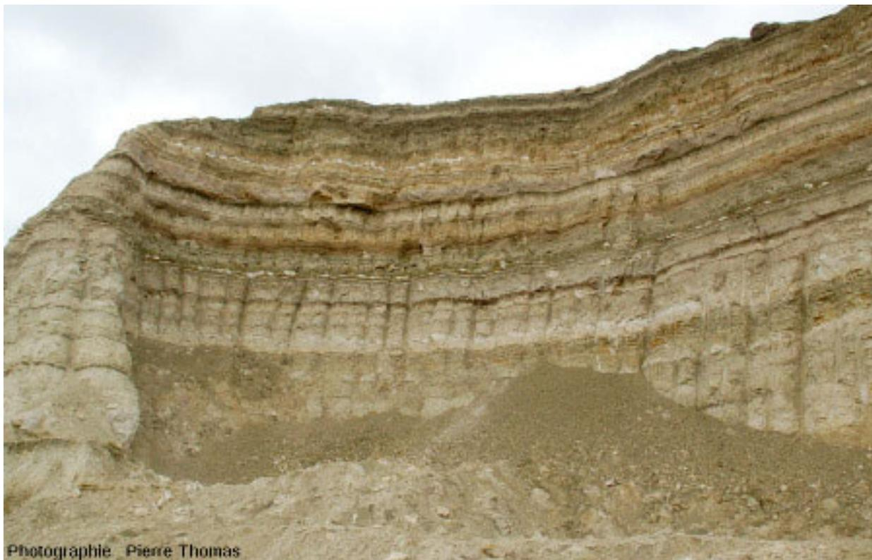
*Figure 20 - Vue de l'un des fronts de taille de la carrière de Gondailly (Allier) © 2007 Pierre Thomas, Cette partie de la carrière exploitaient surtout des argiles et des marnes, qui, mélangées dans des proportions adéquates avec des calcaires font partie des ingrédients nécessaires à la fabrication du ciment. Deux niveaux à stromatolithes sont nettement visibles sous forme d'alignements de petites boules blanches.*
