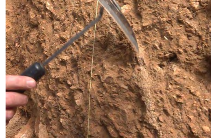
La bande blanche verticale à la pointe de l'instrument serait une trace d'une activité sismique antérieure • © N. Ferro / FTV
