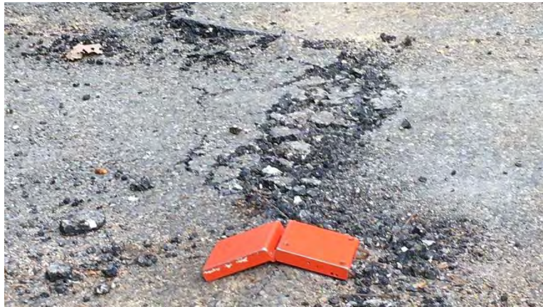
La trace laissée en surface par la rupture peu profonde de la faille de la Rouvière au Teil (Ardèche) - JF RITZ (Géosciences Montpellier), S BAIZE (IRSN), C LARROQUE (GéoAzur), M Ferr
