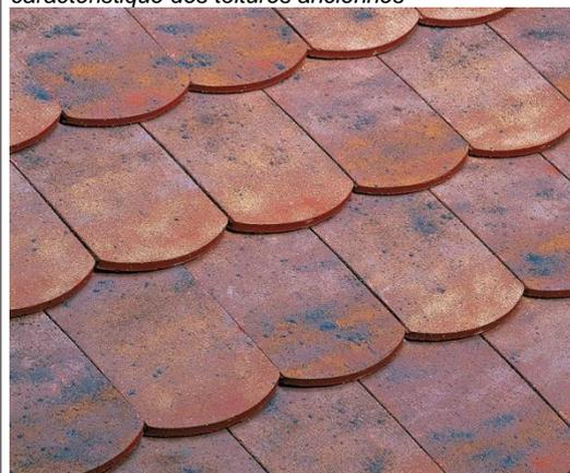
*Tuile plate à emboîtement, écaïlle (22/m<sup>2</sup>). Le recouvrement est minime, ce qui donne des toitures plus raides, moins épaisses, donc plus éloignées des toitures traditionnelles en tuiles écaïlle*
