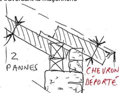
Système avec rehausse de l'avant-toit
