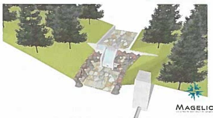
*Figure 4 : Vue de la prise d'eau projetée*
