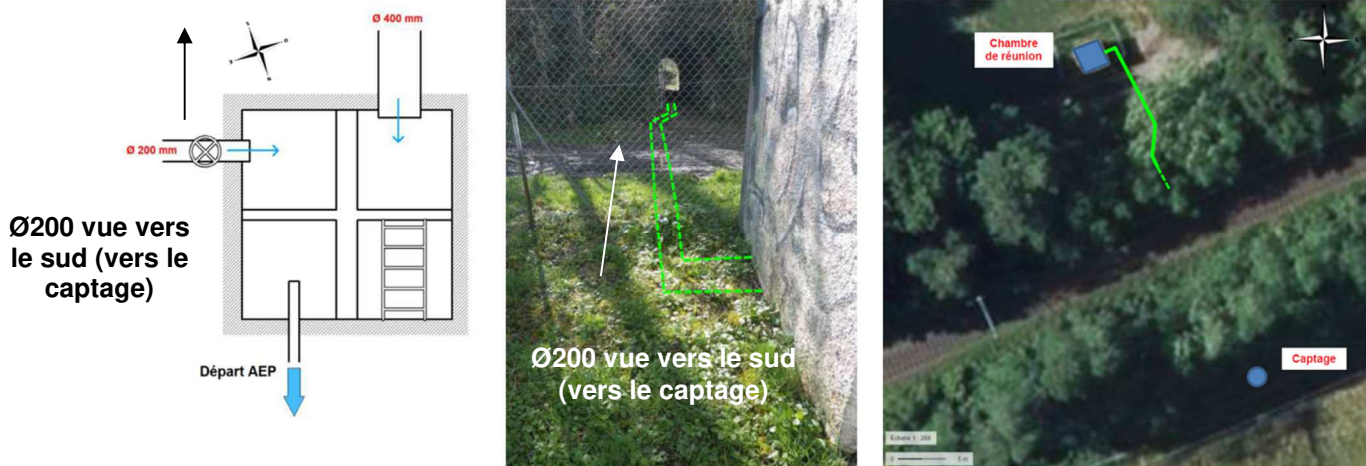
Figure 17 : Implantation de principe de la canalisation en 200mm de chambre de réunion du Bois d'Anthy (source : rapport d'inspection de CPGF-Horizon du 12/03/2020)
