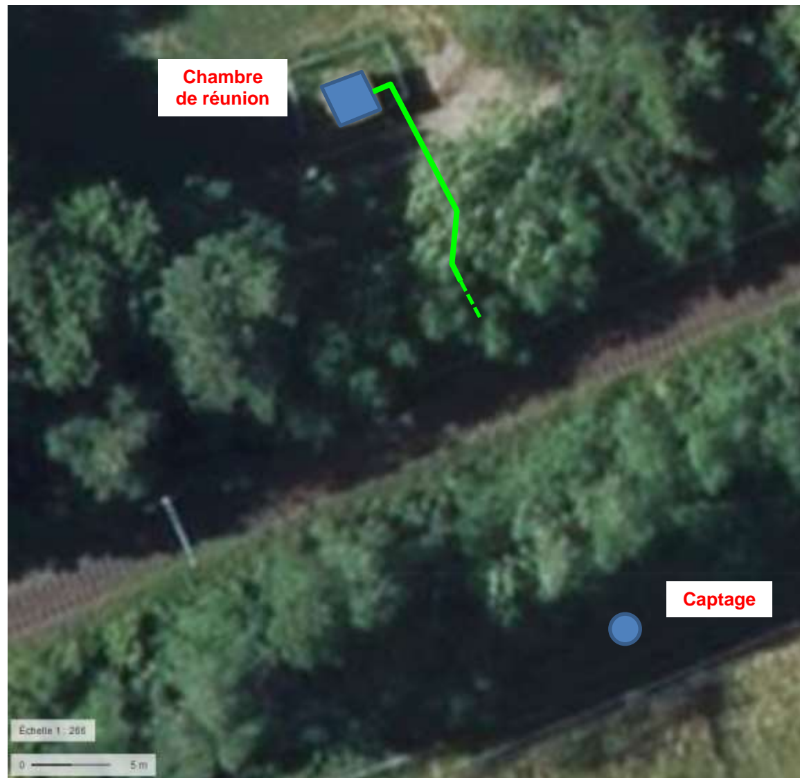
Figure 4-2 : Implantation de principe de la canalisation en 200mm de chambre de réunion du Bois d'Anthy
