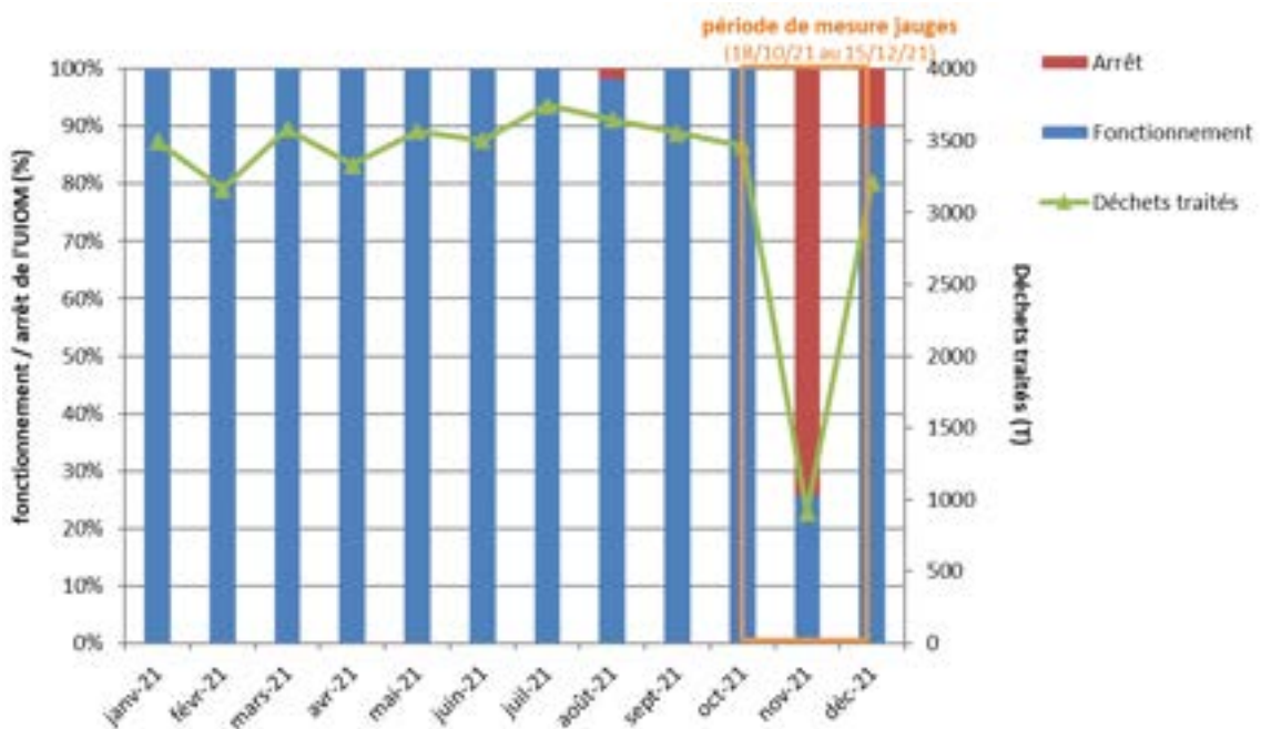
Figure 6. Données de fonctionnement de l'incinérateur de déchets de Thonon-les-Bains
