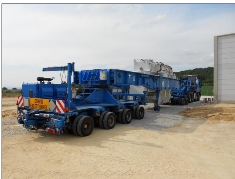
Exemple de convoi transportant un transformateur
