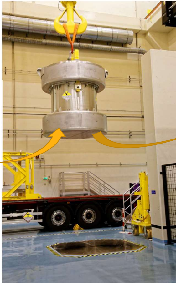
Emballage R73 de transport de déchets
