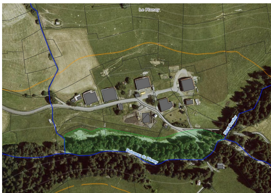
Figure 40: Emprise indicative des dépôts de matériaux (hachures vertes) visibles en rive droite du torrent du Planay après la crue de 2015.
