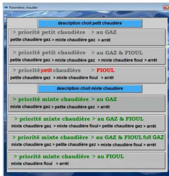
Vue de supervision : grafcet fonctionnement chaudière
