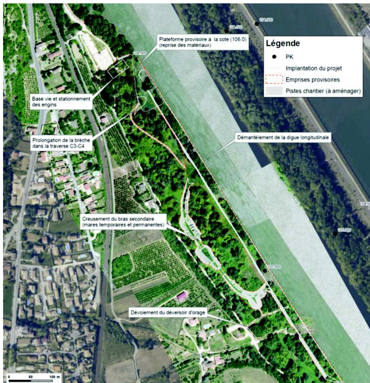
Figure 74 : projet sur les casiers 3 à 8.
