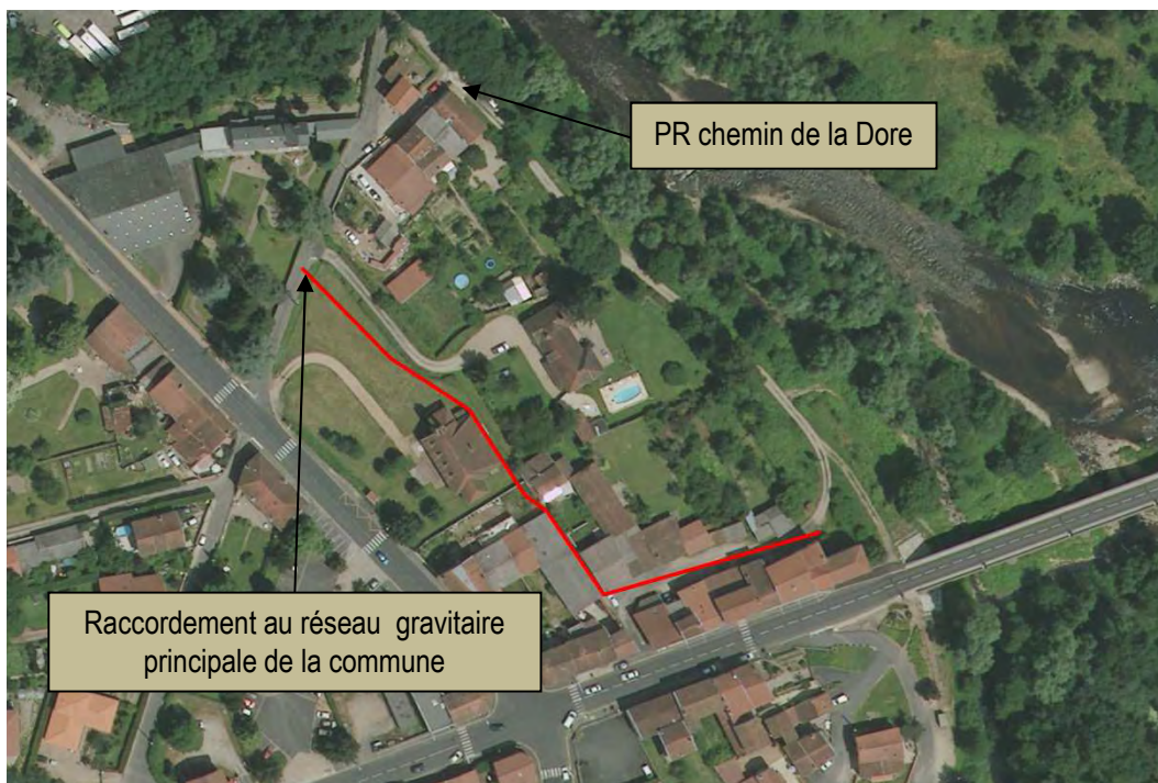
Ossature des réseaux de l'antenne de la Chapelle du chemin de la Dore
