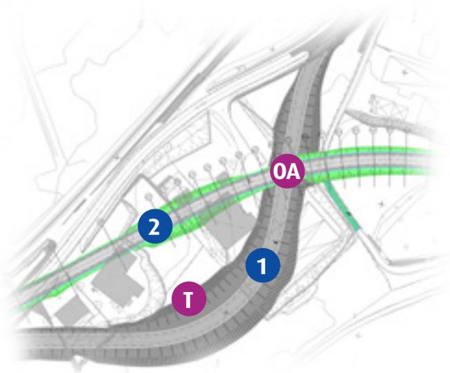
Pour les réaliser, **des terrassements T** sont nécessaires : 80 000 m<sup>3</sup> de matériaux extraits pour rétablir la RN122 actuelle sous l'OA7
