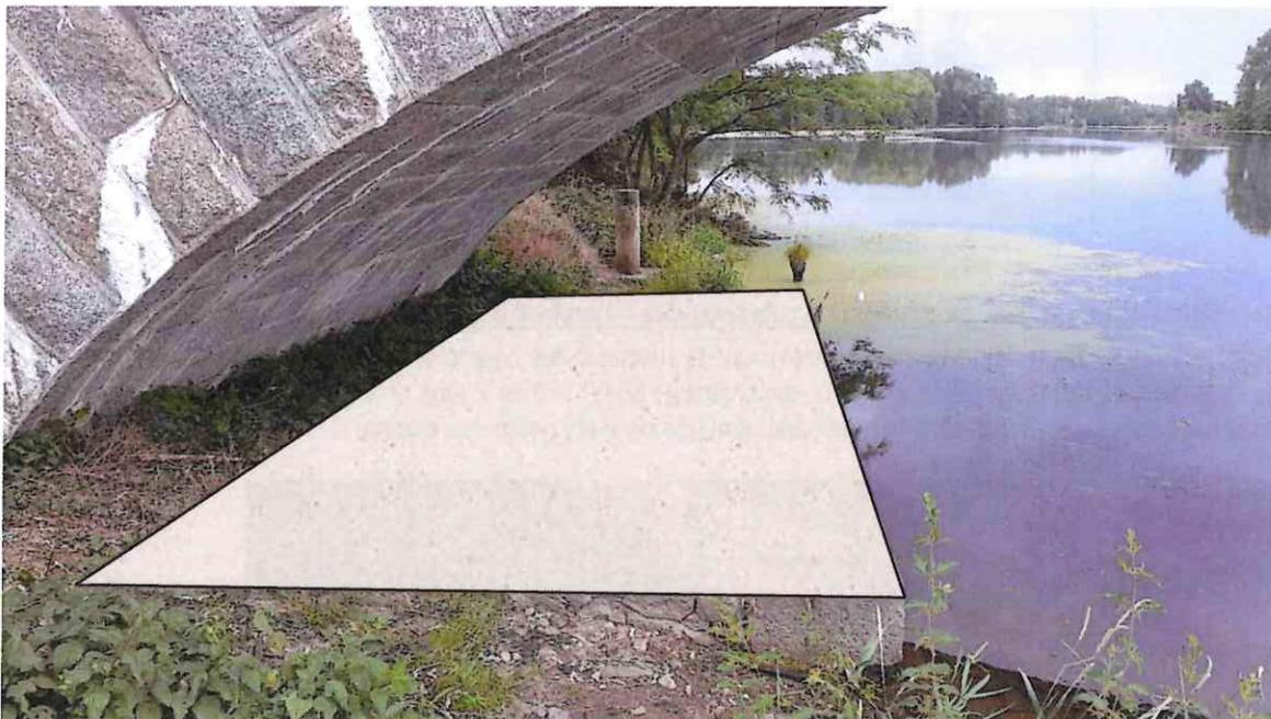
Principe d'aménagement d'une dalle en mortier fibré pour assurer la continuité de la voie « modes doux » sous le pont de la RD1089
