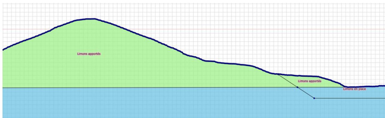
Figure 23 : Coupe de calcul - Rive droit amont (analyse côté Stade de tir)
