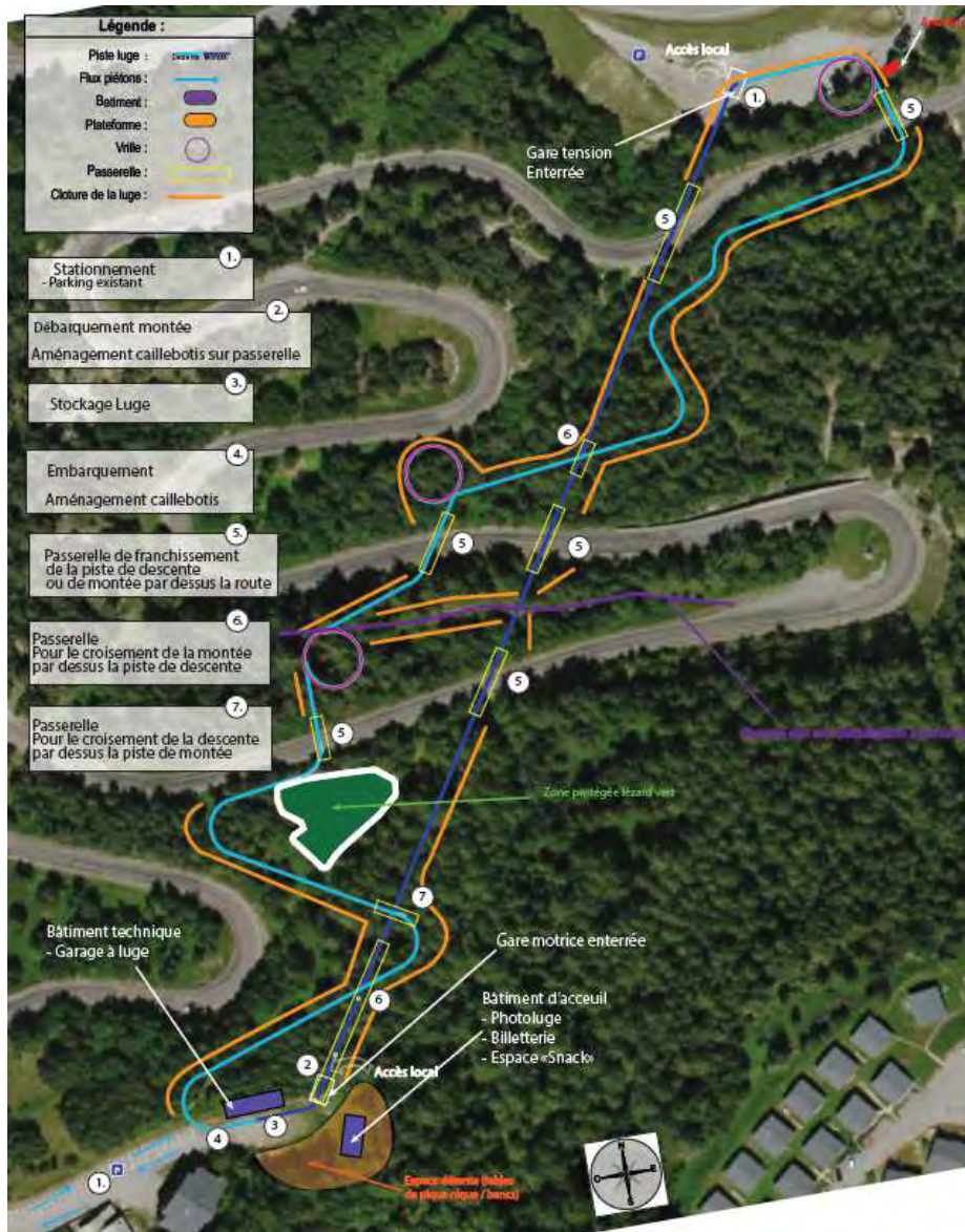
Figure n°2 – Vue aérienne : implantation des ouvrages (source MTC)
