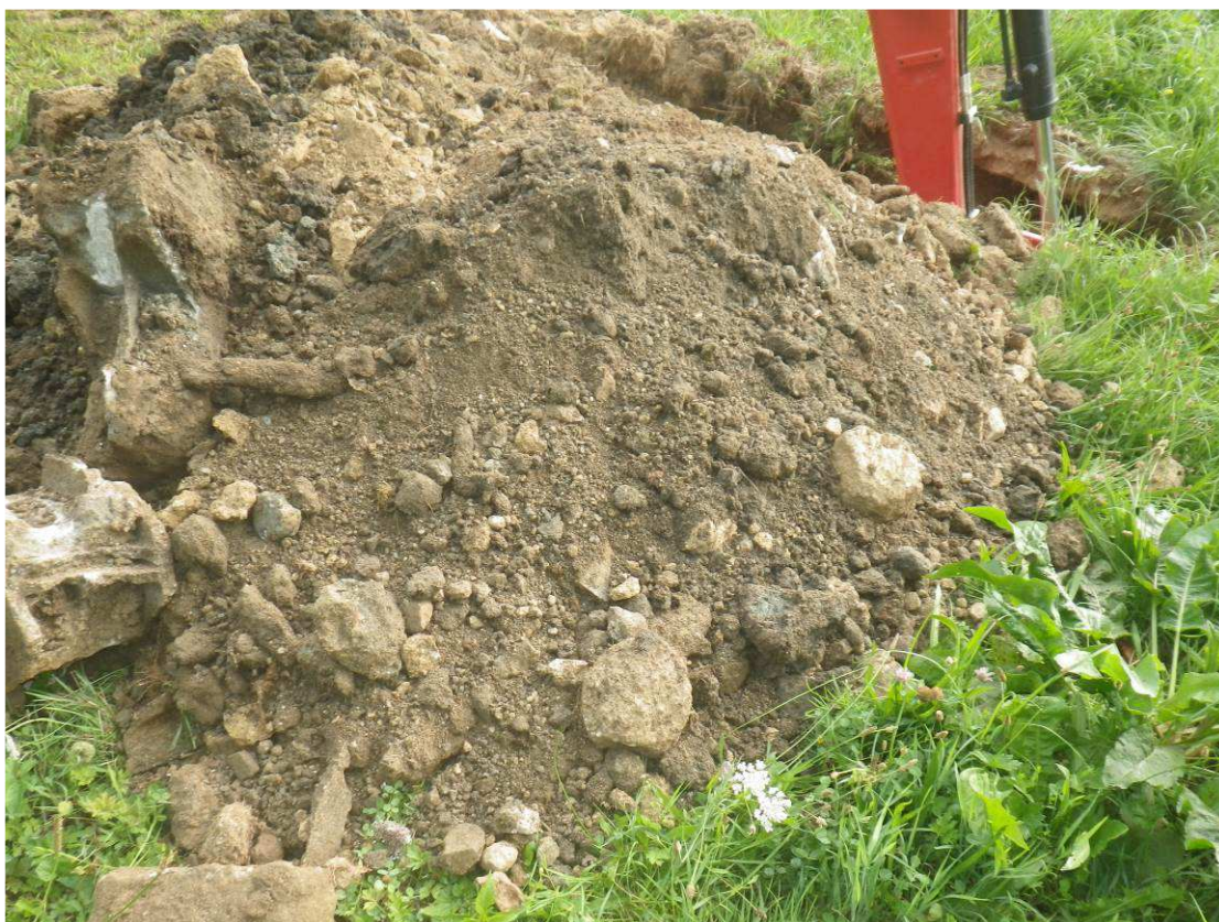
Remblai sablo-limoneux marron gris avec béton, briques et blocs
