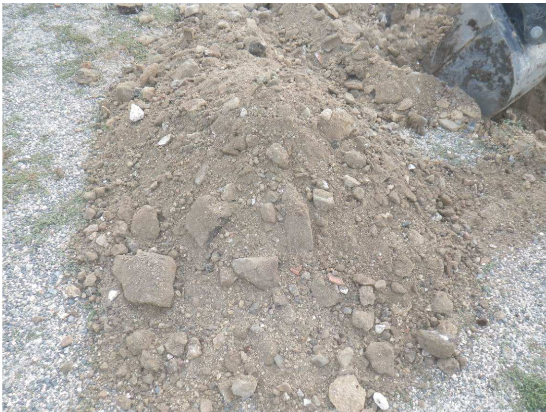
Remblai sablo-graveleux beige avec brique, bois, enrobé et blocs
