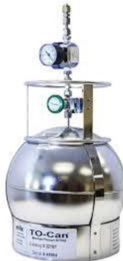
Photographie 1 : Vue du dispositif de prélèvement d'air ambiant par canister
