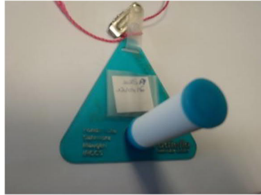
Photographie 2 : Vue du dispositif de prélèvement passif d'air ambiant par Radiello®
