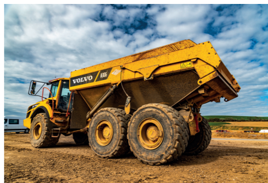
Le tombereau transporte les matériaux entre les différentes zones
