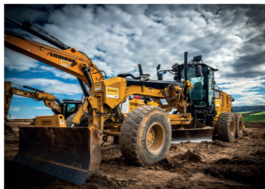
La niveleuse étale les matériaux au niveau du sol souhaité
