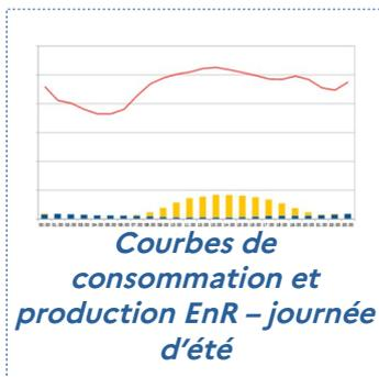
Le photovoltaïque est une énergie variable mais prévisible. Elle s'inscrit dans le mix énergétique, de façon complémentaire aux autres sources d'énergie décarbonée.
