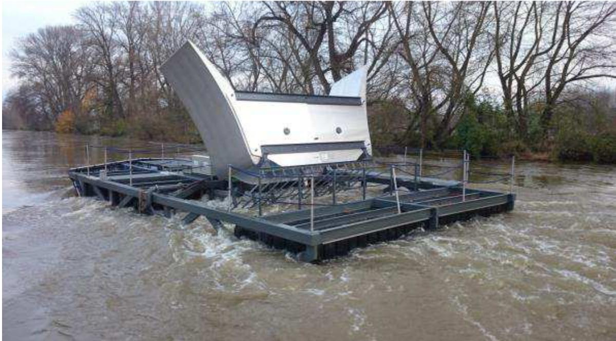
Hydrolienne un étage sur barge flottante en position relevée en position relevée
