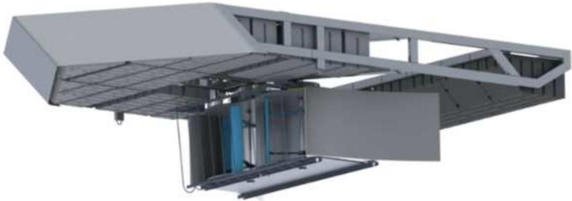
*Hydrolienne un étage sur barge flottante en position de fonctionnement*
