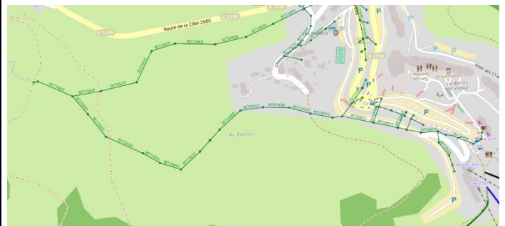
SCHEMA DU RESEAU PLUVIAL EN CONCORDANCE AVEC LE PROJET
