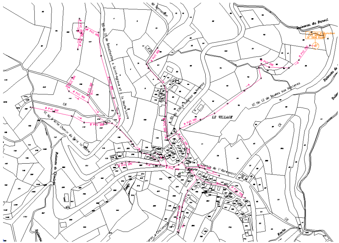
Figure 3-2: Plan du réseau d'assainissement des Nonières
