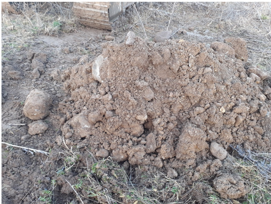
Sables graveleux provenant des chantiers de la ZAC de la Quarantaine à Villefranche sur Saône et de la Zac du Marverand à ARNAS
