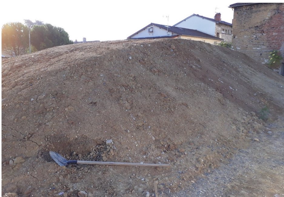
Limon sableux provenant du chantier de la ZAC de la Quarantaine à Villefranche sur Saône
