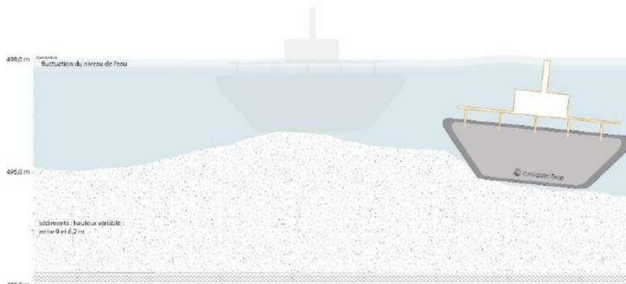
Figure 206 : Dimensions de la drague par rapport aux profondeurs du bassin (ordre de grandeur)
