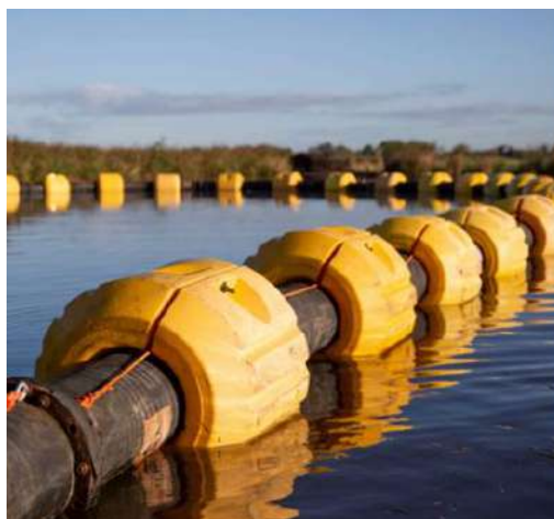
Figure 41 : Exemple de conduite flottante utilisée pour les chantiers de dragage par pompage dilution
