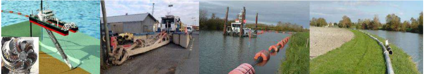
Figure 35 : Exemple d'illustrations de drague conventionnelle (drague aspiratrice stationnaire) (IDRA, 2022)
