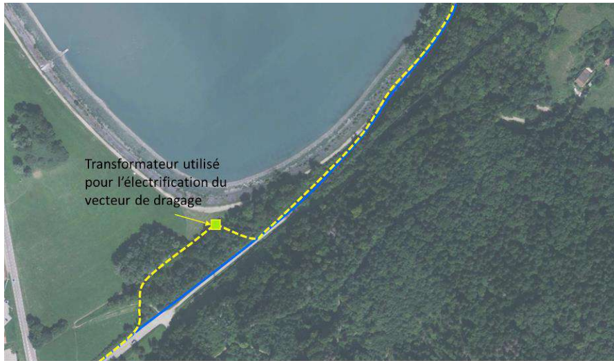
Figure 12 : Schéma de principe du dévoiement/enfouissement de la ligne HTB 20 kV (en bleu : ligne actuelle, en jaune : projet, en continu : ligne aérienne, en pointillé : ligne enterrée). Nota : il ne s'agit pas du tracé définitif qui pourra être amené à être modifié
