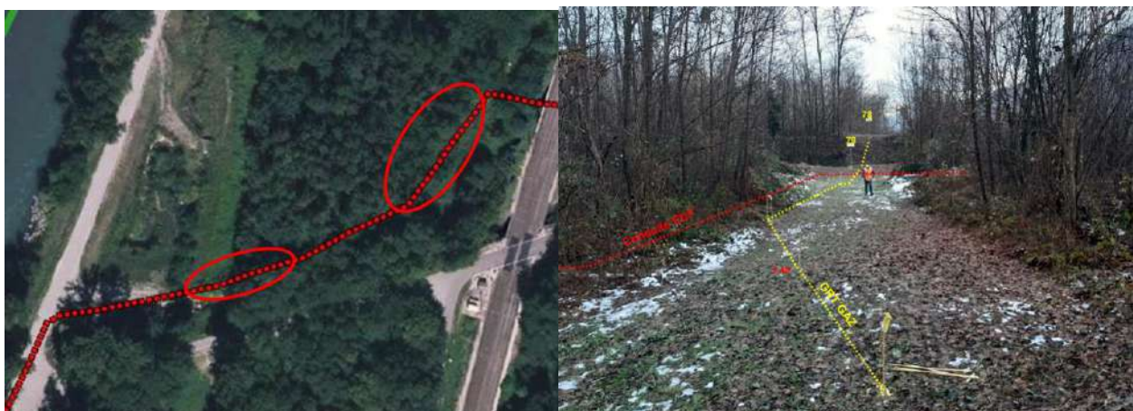
Figure 189 : Secteur concerné par un élargissement de la tranchée existante de GRT Gaz (les cercles rouges montrent les secteurs dans lesquels des débroussaillages et abattages seront nécessaires, ils n'indiquent pas la zone totale à traiter)
