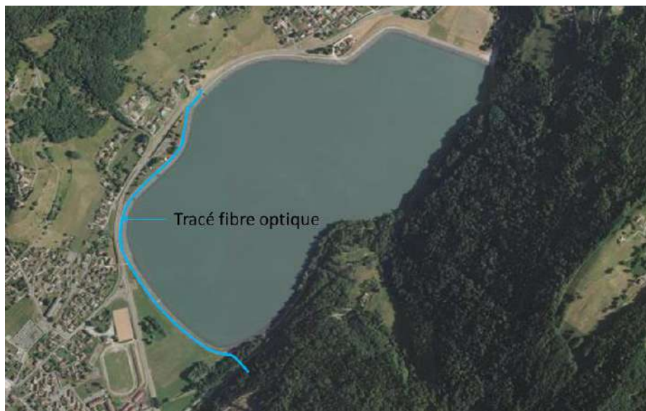
Figure 30 : Tracé de la fibre optique à installer
