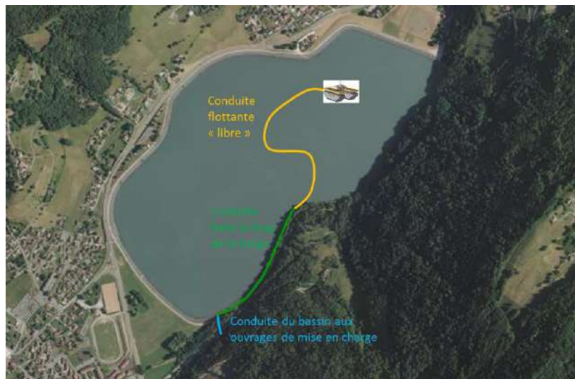
Figure 42 : Schéma de principe du tracé de la conduite à proximité du bassin (devra être adapté à chaque zone à curer). Le schéma de principe sera identique sur le bassin du Cheylas
