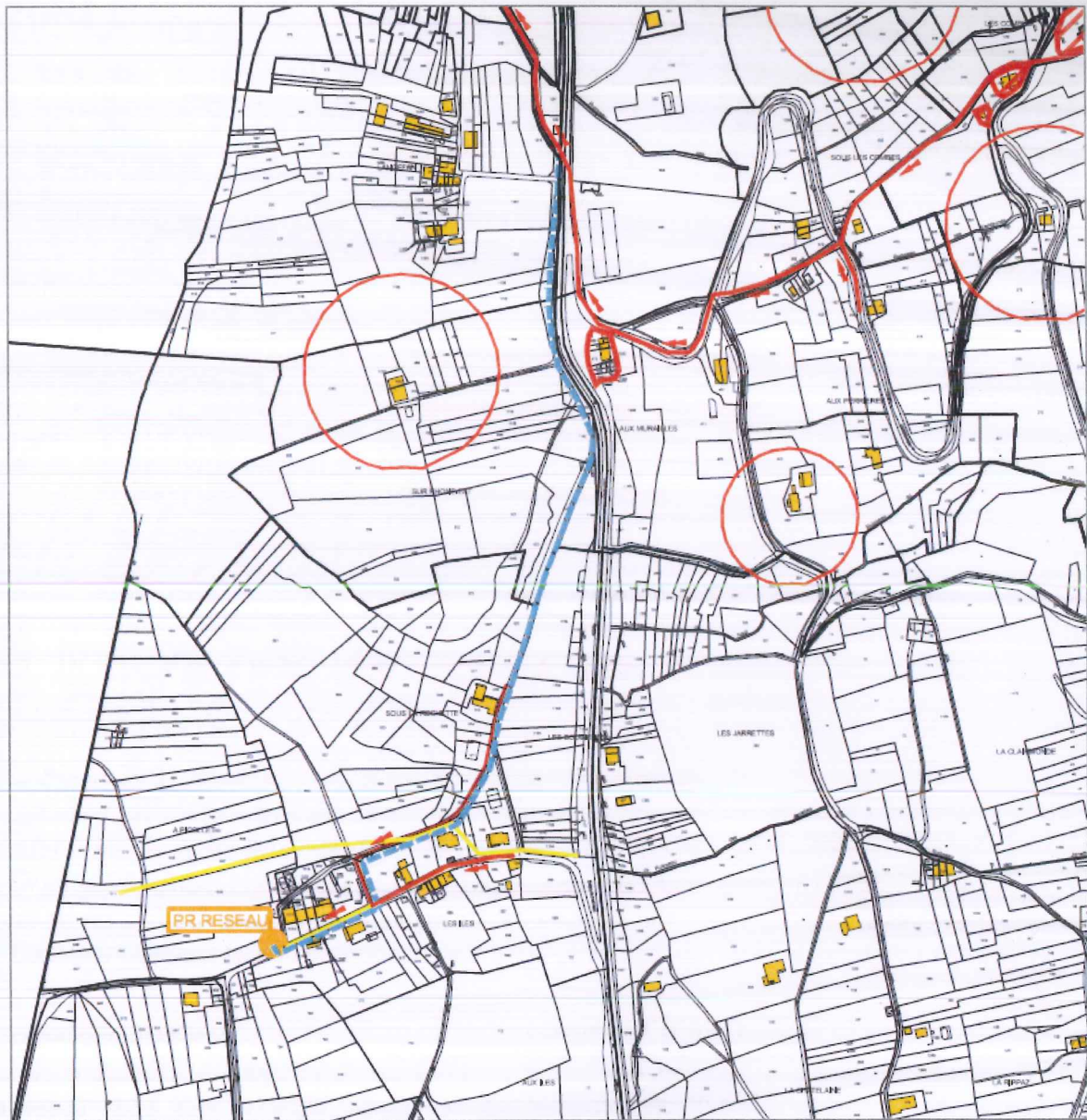
Fig. 3-c : Raccordement du hameau des îles par refoulement (source : SINBIO)
