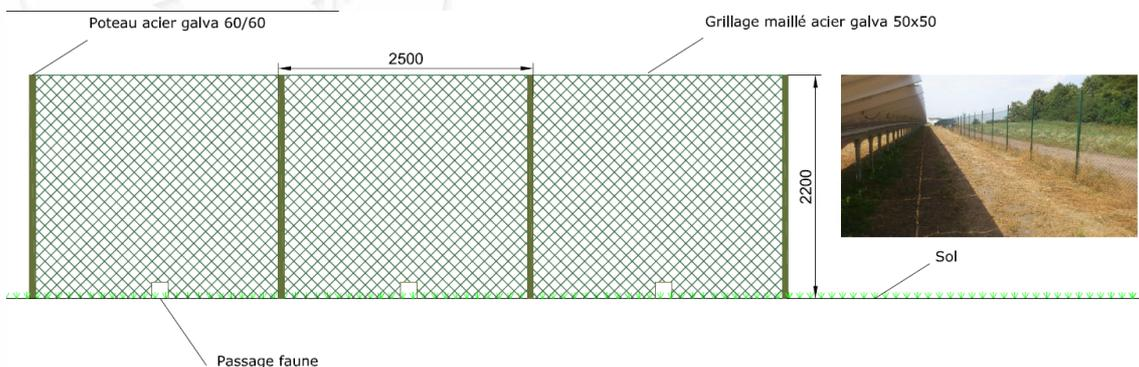
Figure 67 : Exemple d'une clôture facilitant la circulation de la petite faune (Source : Green Energy 3000)
