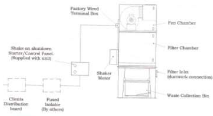
FIGURE 10 : ASPIRATION DES POUSSIÈRES MÉTALLIQUES
