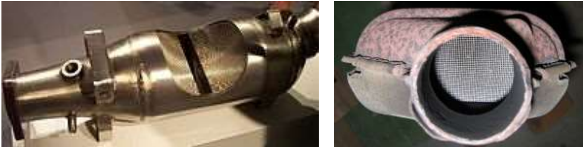
FIGURE 4 : VUE « EN ECORCHE » D'UN POT CATALYTIQUE A ENVELOPPE EN INOX ET VUE DE LA STRUCTURE INTERNE D'UN POT CATALYTIQUE
