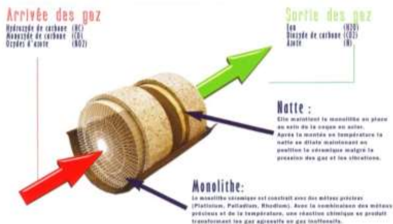
FIGURE 5 : SCHEMA D'UN POT CATALYTIQUE (AVEC L'AIMABLE AUTORISATION DE MECA-EXPRESS)
