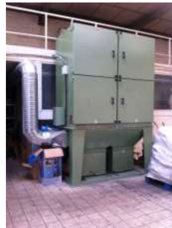
FIGURE 10 : ASPIRATION DES POUSSIÈRES MÉTALLIQUES
