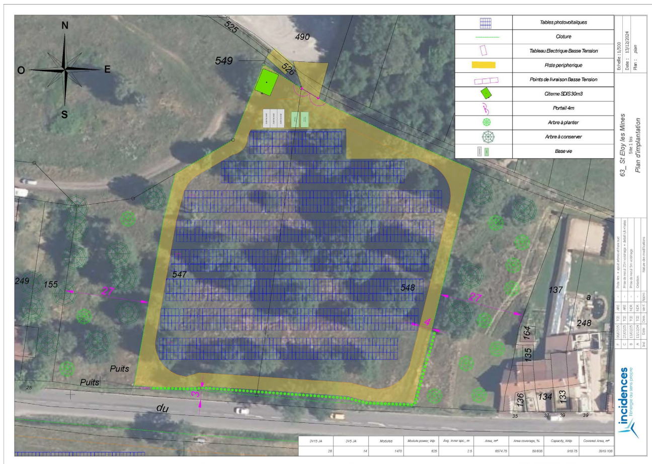
Figure 9 : Plan d'aménagement de la centrale photovoltaïque
