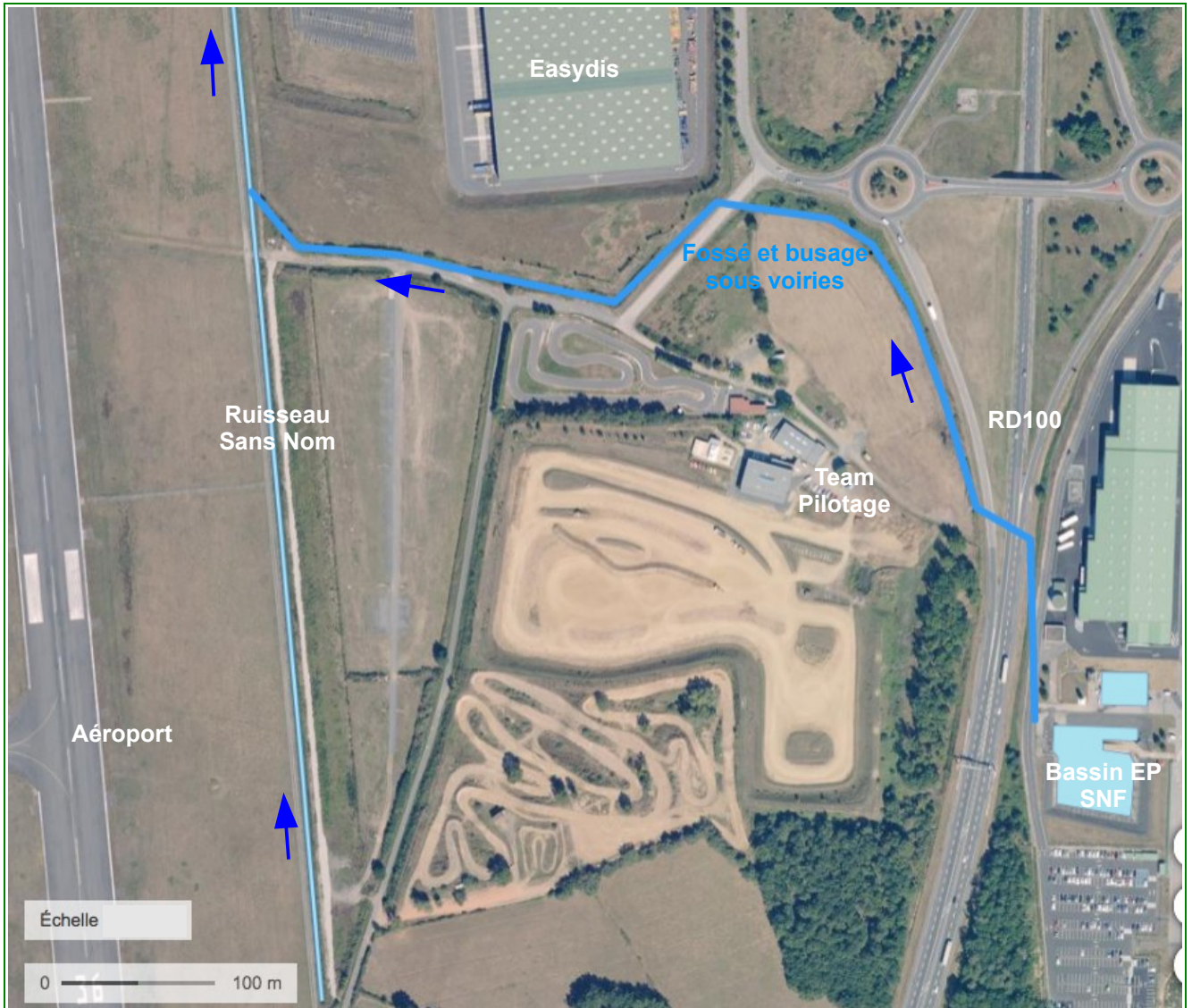
Illustration 10 : Evacuation des eaux pluviales
