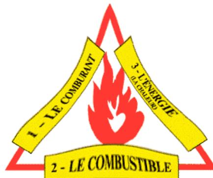
*Figure 10 : Eléments nécessaires pour le déclenchement d'un incendie*
