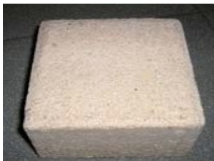
pavé en béton poreux
