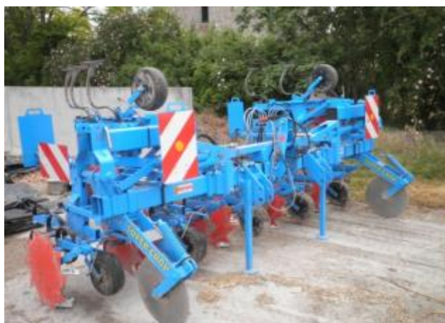
Image 5 : Bineuse équipée d'une rampe de pulvérisation localisée (Bilan MAEt et animation agricole 2012-2013) (source : LFa)
