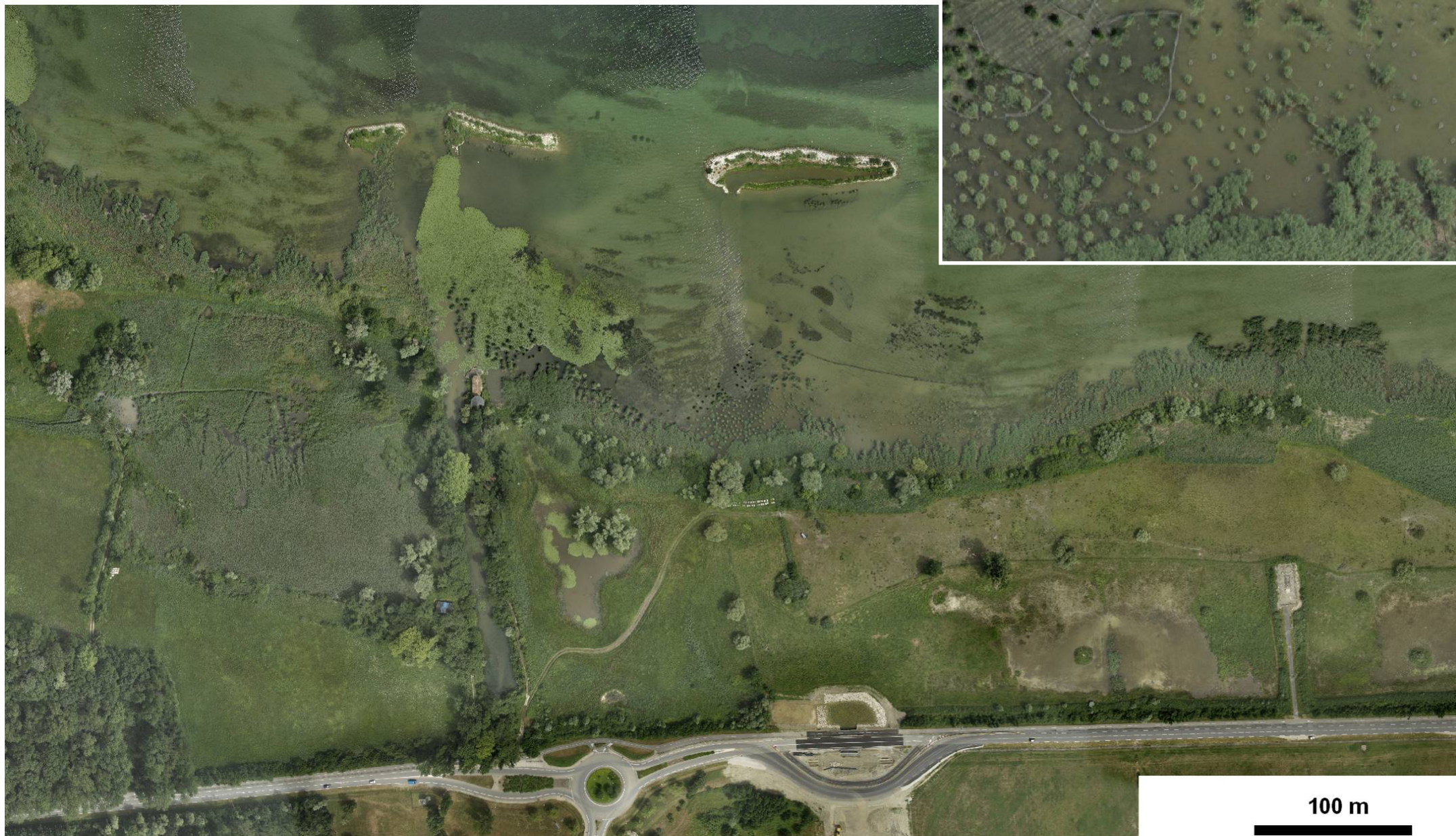
Figure 6. Restauration des roselières du sud du lac du Bourget (état juillet 2006) : îlots, Fascine de contention des matériaux, enclos de protection ; à noter les touffes en train de se rejoindre en bas à g. du zoom, et les enclos individuels vides des touffes mortes dans la partie droite).
