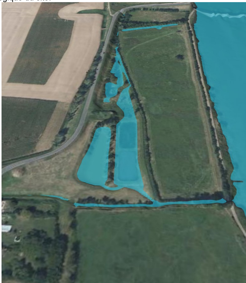
En bleu, la modélisation de la zone ennoyée avec un niveau d'eau retenu à la cote de 172.6 m NGF
