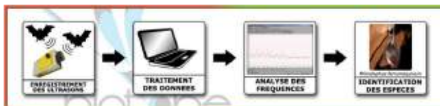
Schéma du principe de détection des chauves-souris et de définition de l'activité par suivi ultrasonore
