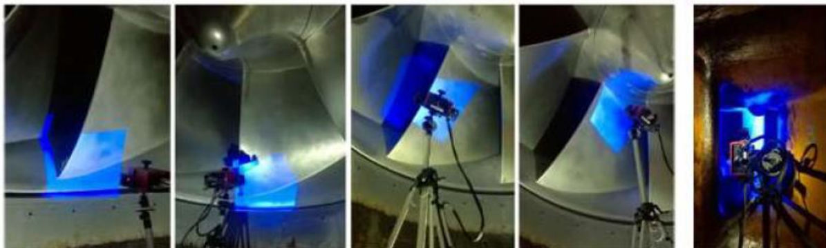
Figure 11 : Mesure des surfaces par photogrammétrie laser (scan 3D) (Source : EDF)
