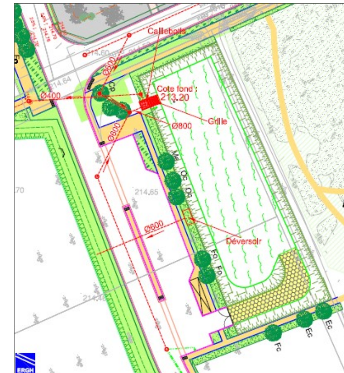
Figure 33 : Conception écologique des bassins de gestion des eaux pluviales
