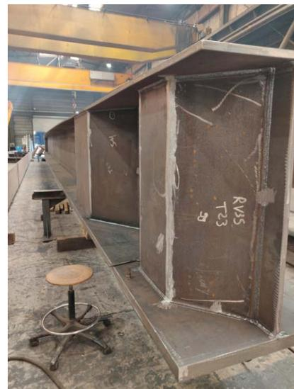
Fabrication d'une poutre principale en atelier
